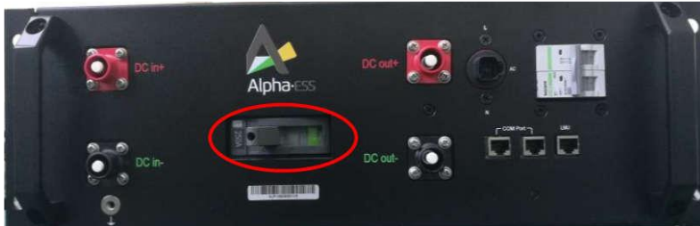
Obrázek 6. Kompaktní jistič ve vypnuté poloze
