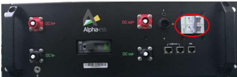
Obrázek 7. Spínač střídavého proudu v poloze ON
